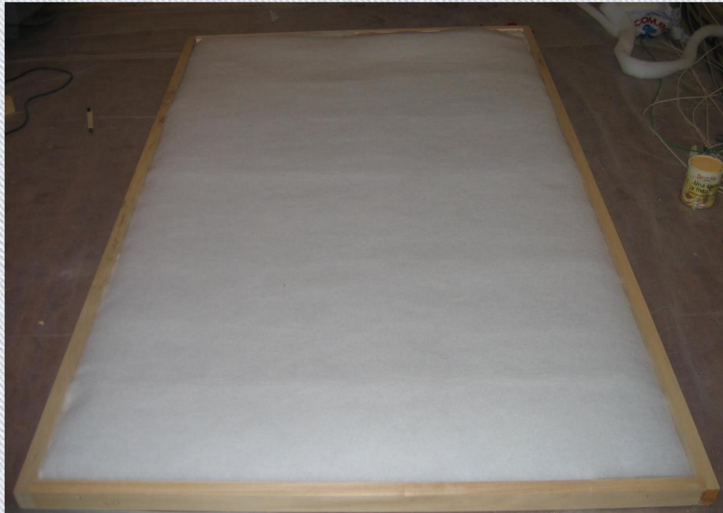
Para evitar la desagradable “pelusilla” que puede ir soltando con el tiempo la fibra de vidrio, recubrimos la parte anterior del panel con una lamina de guata.
